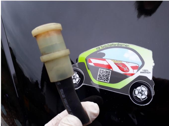
Originalentlüftung, so wie sie auf dem Getriebe steckt.
