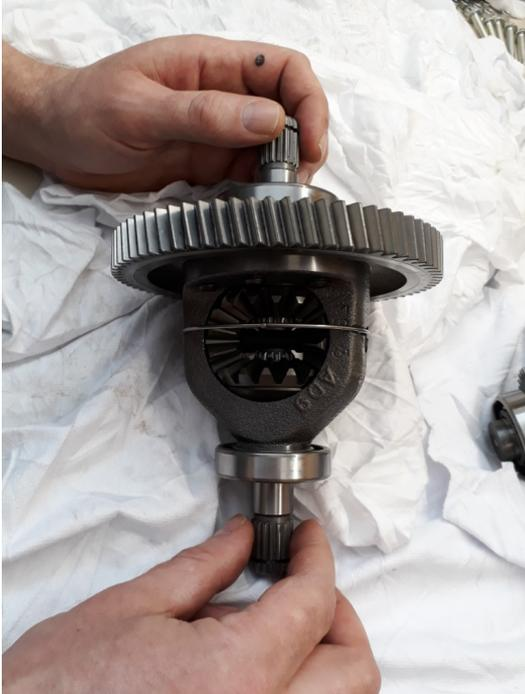
Bild 1: Differential nach Ausbau aus dem Getriebe
