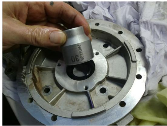
Nach der Demontage der alten Simmerringe können die neuen Simmerringe mittels z.B. 30er Nuss eingesetzt werden. Für die Montage der Simmerringe der Ausgangswelle empfiehlt es sich jedoch eine Messinghülse zu benutzen, wie im Bild oben dargestellt. Diese wurde jedoch extra für den Zweck angefertigt. Möglicherweise findet man aber auch einen anderen geeigneten Adapter für die Montage.
