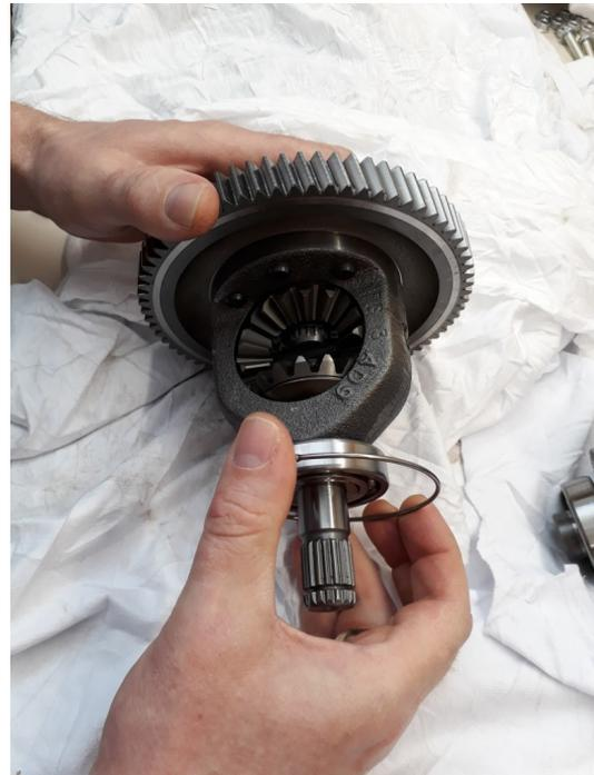
Bild 2: Stahlsicherungsring abziehen
