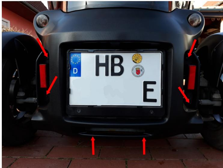
Steckverbindungen lösen (Kennzeichenbeleuchtung)
