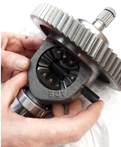
Bild 10: Welle der Kegelzahnräder montieren
