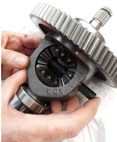
Bild 10: Welle der Kegelzahnräder montieren
