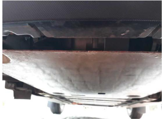
Oftmals ist das Bodenblech ölverschmiert, bedingt durch defekte Simmerringe oder Getriebedichtungen. Oder bedingt dadurch, dass aus der Getriebeentlüftung das Öl raus gedrückt wird. So war es in meinem Fall. Hierzu habe ich die Entlüftung mittels Benzinschlauch verlängert. Dazu später mehr. Siehe 5-1
