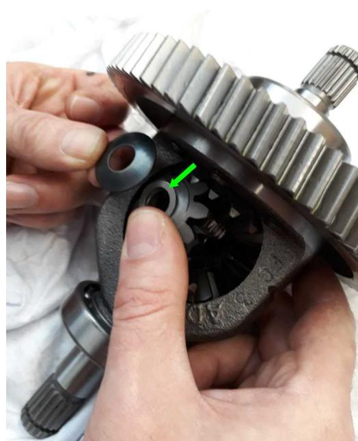
Bild 9: Einsetzen der Zusatzscheibe
