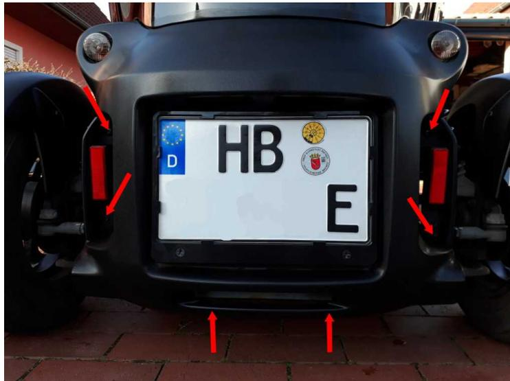
Steckverbindungen lösen (Kennzeichenbeleuchtung)
