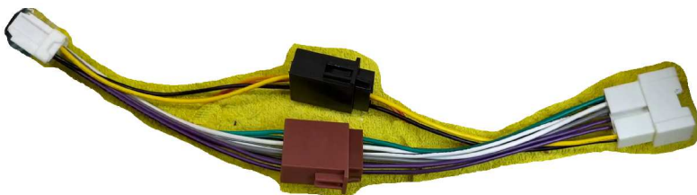
12 Pin Stecker, Lautsprecher und Spannungsversorgung
