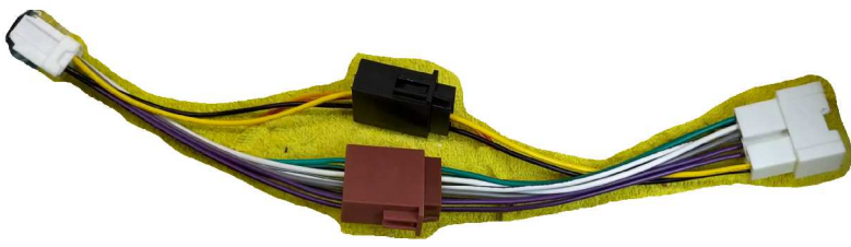
12 Pin Stecker, Lautsprecher und Spannungsversorgung
